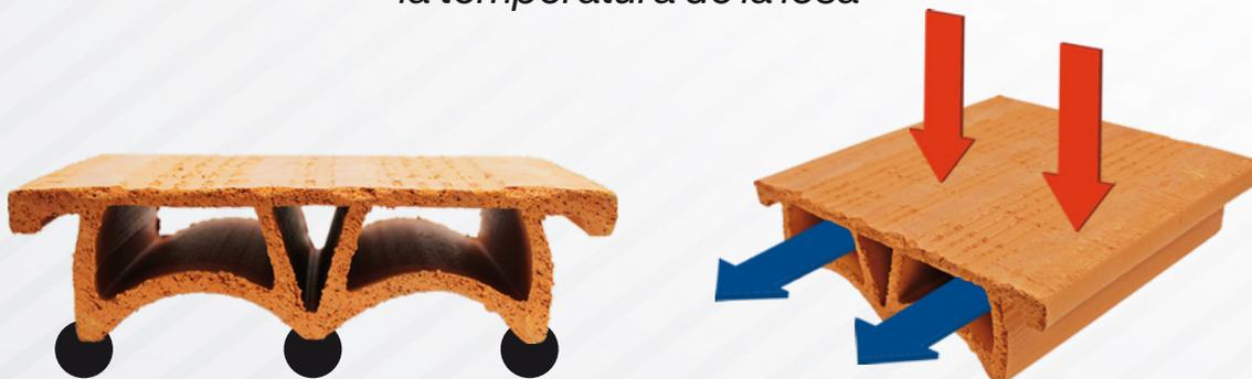
**Al no estar unido a la losa, sino solo sobrepuesto, provoca una “interfase” que rompe la trasmisión de calor del sol a la losa.**
